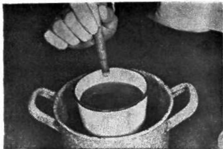
Рис. 48 — Изготовление мисочек способом погружения шаблона в воск
